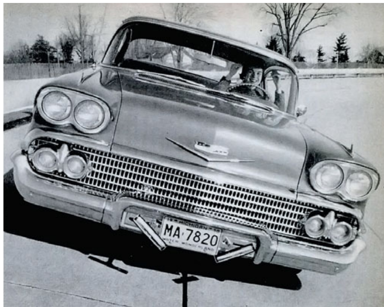
Abb. 3.6 Automatisches Fahren auf einer GM-Teststrecke 1958 ([20], S. 75)
